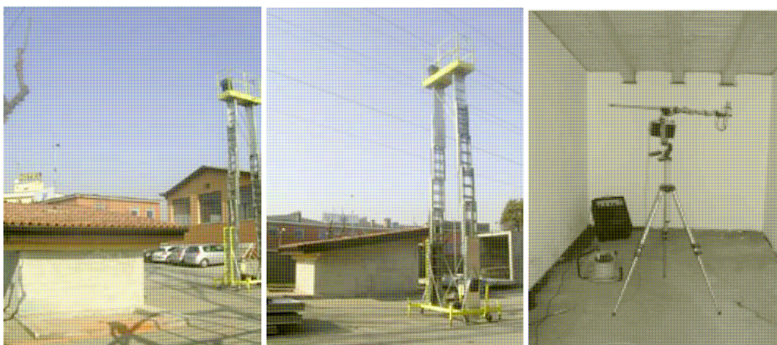
Figura 2: - Allestimento di prova in cella esterna: a destra e al centro posizione della sorgente di rumore su di un trabattello mobile direzionata al centro della copertura con un angolo di (45\pm 5)^\circ . A sinistra misura del tempo di riverberazione.
